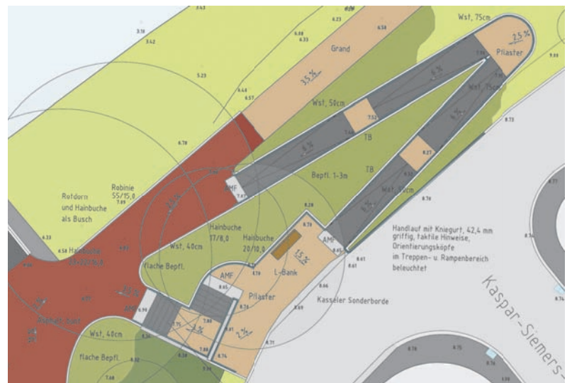
Barrierefreier Zugang vom Wohnquartier zum Grünzug Schleemer Bach als Rampenlösung (Entwurf: EGL, Hamburg)
